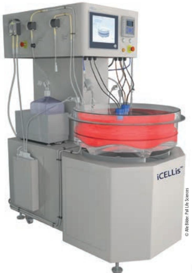
Höhere Kapazitäten mit Single-Use Fixed-Bed Bioreaktoren
