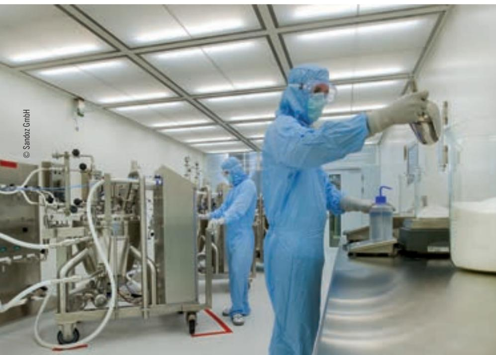
In der Ansatzherstellung werden biopharmazeutische Wirkstoffe aufgetaut, eingewogen und mit Zusatzstoffen zu einer sterilen Fertiglösung verarbeitet.
